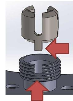
手順⑤ 固定カバーを締めきってから、抜け止めのM2十字穴付きねじを取付けてください。
