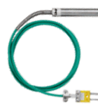
AD-1218-350 針状シース型 -50～700℃ 約φ3.2×350mm ケーブル長：約1m
