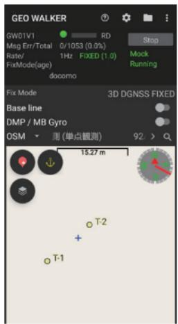
⑥誘導してほしい測点を長押しします。測点と現在地が線で結ばれます。
